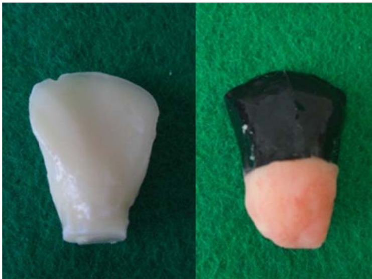
図2. 乳酸溶液で脱灰する試料歯を作製する様子。写真左は牛歯歯根部を切除した状態。写真右は歯根部切除後、脱灰させるエナメル質部分にテープを巻き、それ以外の部分にアクリル系レジンで被覆した状態。
