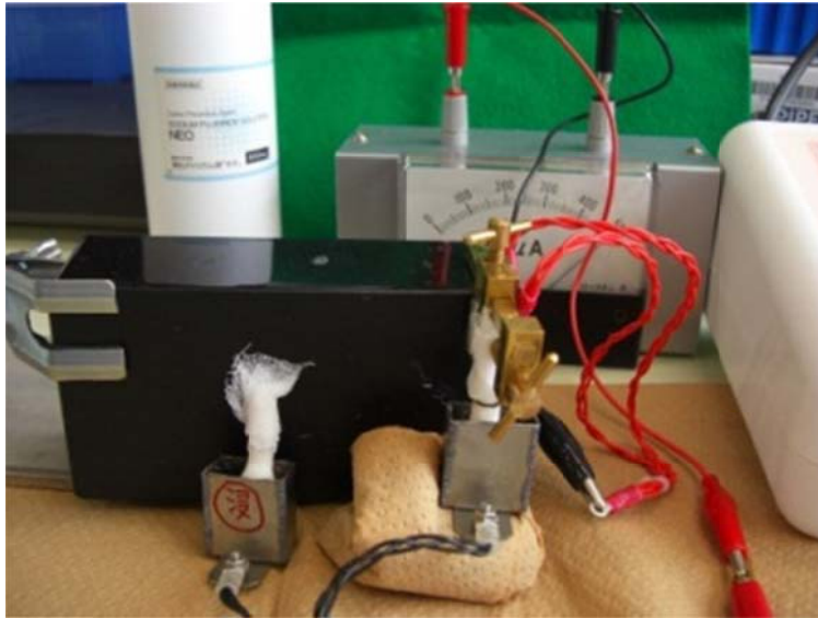
図1. イオン導入法および浸漬法による牛歯へのFイオン導入実験。浸漬槽にNaF溶液を同量入れ、歯冠部分をNaF溶液に浸漬した。左側槽は浸漬のみで、右側槽は牛歯に500 \mu Aの通電を行った。
