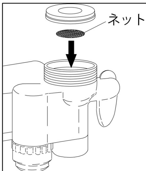
ネットに汚れや異物が付着すると本品の発電能力が低下し、オゾン水の濃度が低下しますので定期的な清掃を行ってください。
