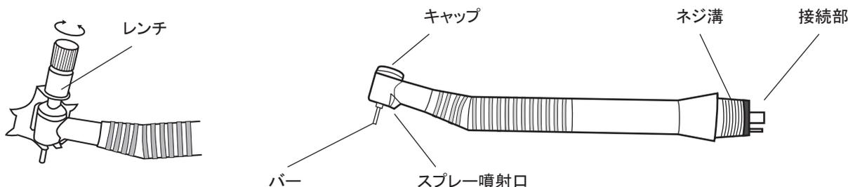
**⚠ 注意** : バーを装着後、バーを指で引っ張り、確実に保持されているかを確認してください。1度に締めこまず、バーの状態を確認しながら装着してください。
