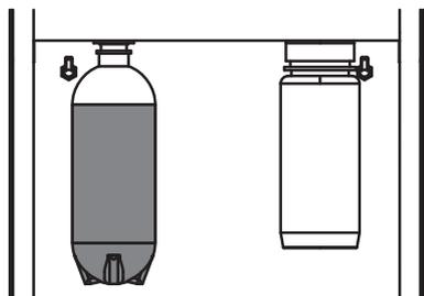
治療中に水を補充する場合は、一旦給水スイッチをOFFにして、給水ボトル内の空気圧が抜けたことを確認後、給水ボトルを取り外し水を補給してください。
