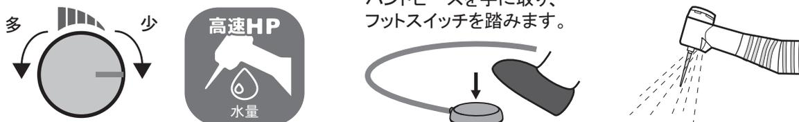
**注意** この時、バーは高速回転しますので、十分注意して水量調節を行ってください。高速ハンドピース使用時は、必ず十分な注水下で使用してください。
